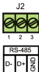
Rys. 3. Widok złącza komunikacyjnego J2 ściemniacza LED SCL-3P
