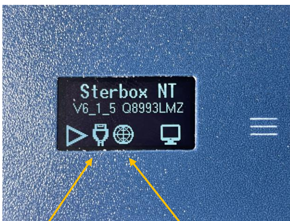
Podłączony kabel LAN
